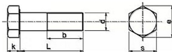
Болт, DIN 601, клас на якост 4.8, поцинкован, частична резба
