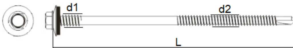
Винт за сандвич панел с шестостенна глава, комплект с шайба, пробивен капацитет до 6 мм.
